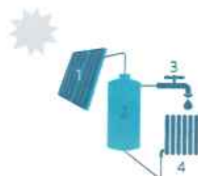
1. Zonnecollector | 2. Opslagvat zonneboiler | 3. Sanitair warm water | 4. Afgiftesysteem voor ruimteverwarming (optioneel)
